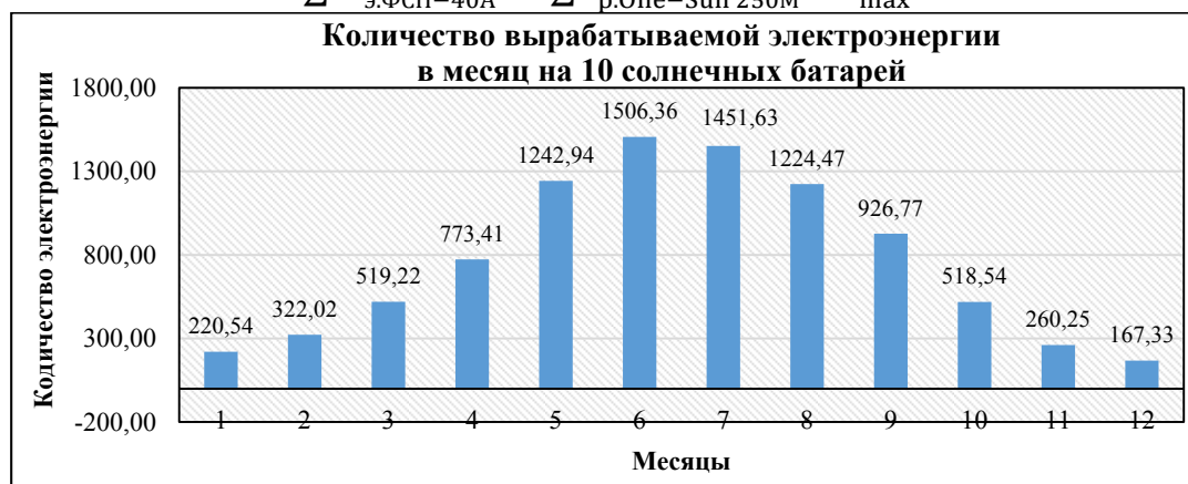
Рисунок 4 – Количество вырабатываемой электроэнергии в месяц на 10 солнечных батарея
